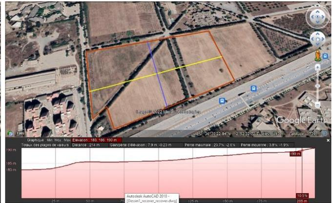
Figure 21: Schéma de pente BB de terrain.
