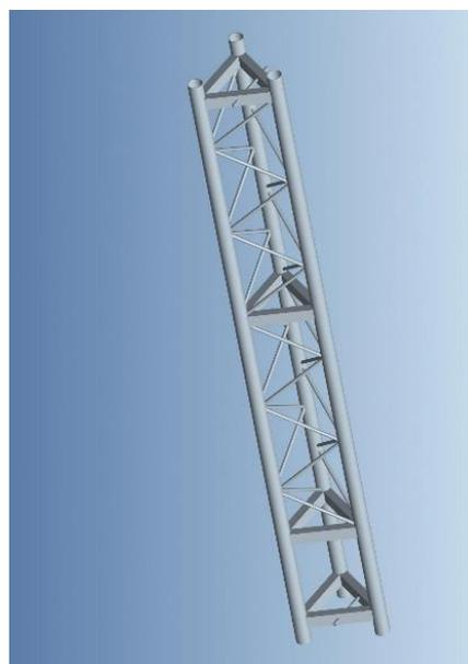
Figure 95: Poteau en section creuse circulaire
