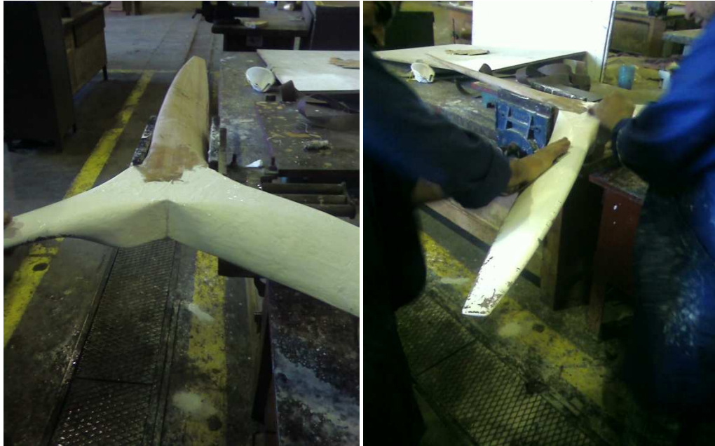
Figure IV-D-3 : Le revêtement avec la résine blanche
