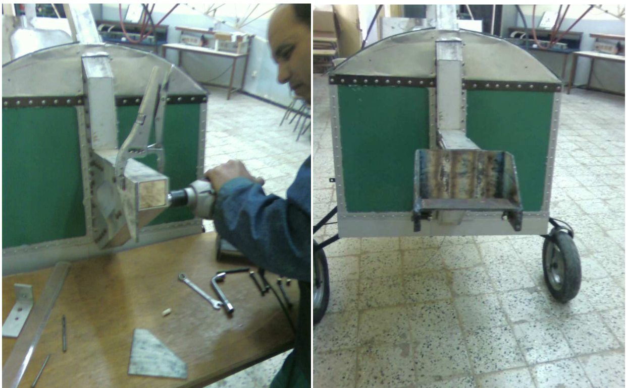
Figure IV-3-3 : Perçage et montage du support palier
