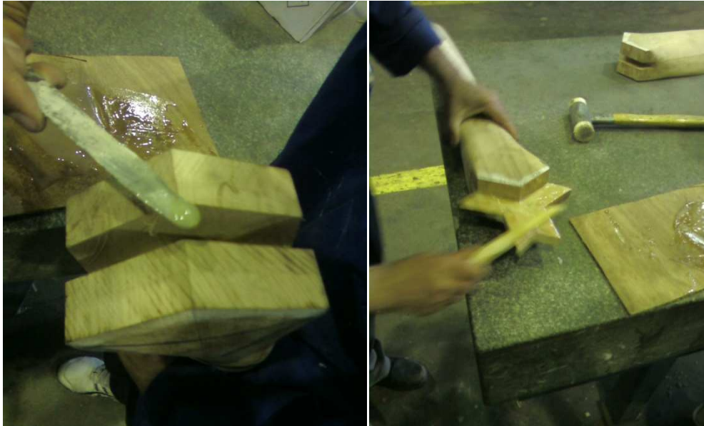
Figure IV-C-5 : Collage des pales
