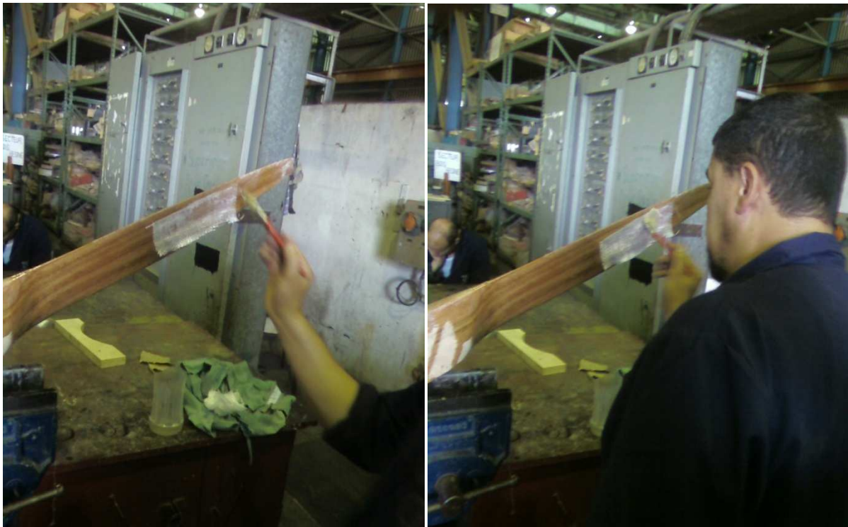
Figure IV-D-2 : Le revêtement avec la fibre de verre et la résine transparente
