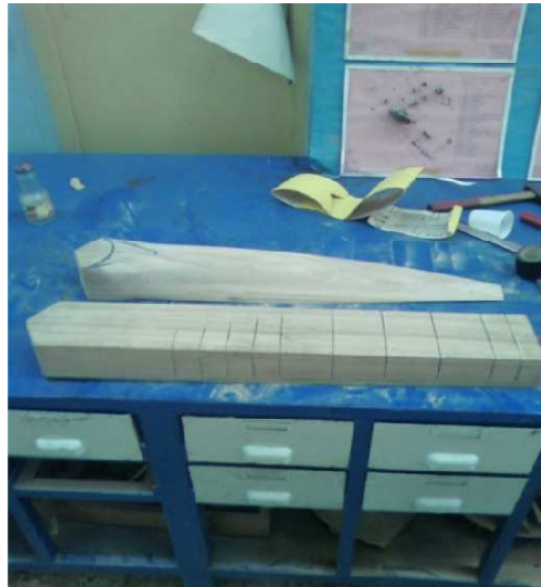
Figure IV-B-6 : Commencement du travail sur la deuxième pale
