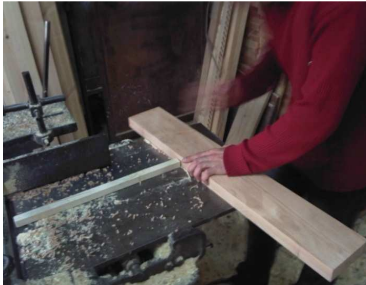
Figure (IV-A-2) : Hachurassions des planches
