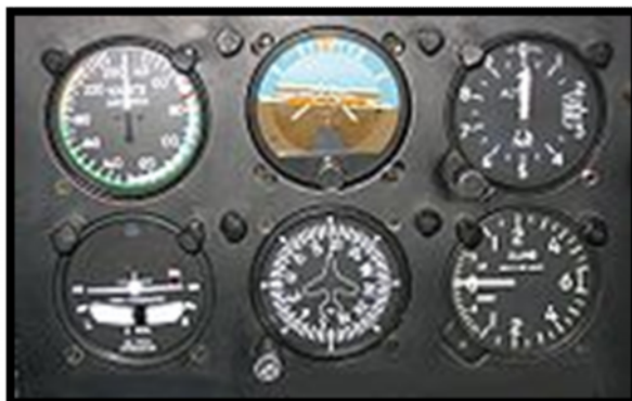
Figure I-2 : Les 4 instruments de base en T complétés par, en bas à gauche l'indicateur de virage, en bas à droite le variomètre.
