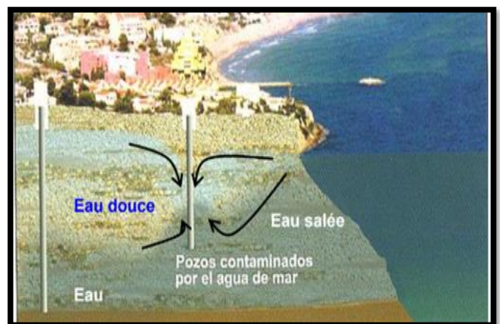
Figure (H.3) : Forages contaminés par les eaux salées [64].
