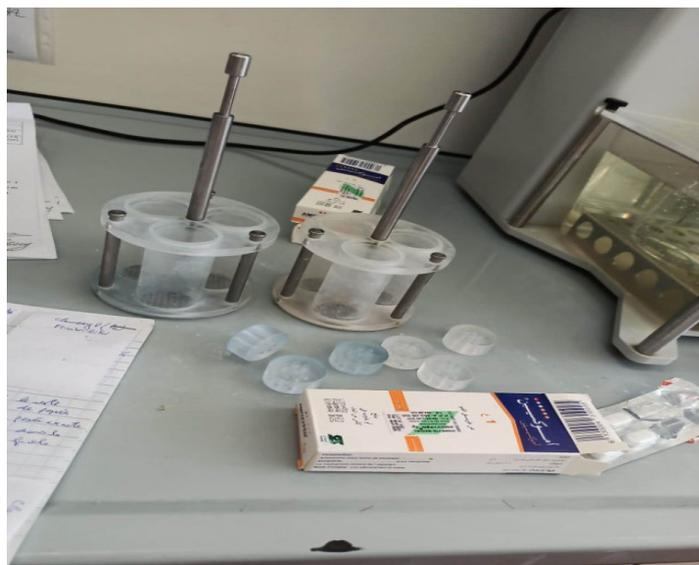
**Figure(II.9) :** Photos réalisées au moment d'introduction des comprimés à désagréger.
