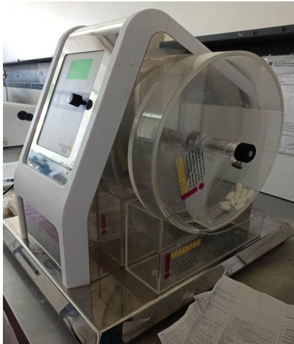
**Figure(II.12) :** Photo d'appareil du friabilimètre.
