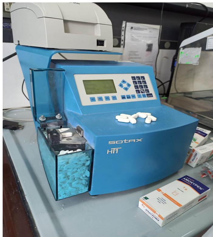
**Figure(II.11) :** Photo représente un duromètre.
