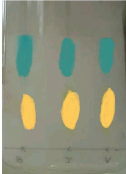
**Figure(II.5)** : Photo d'une plaque obtenue par une analyse CCM d'Amoxypen®(ECH1) et Clamoxyl® (ECH) produit fini.
