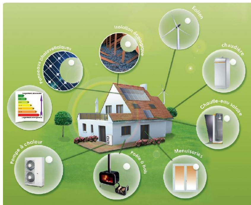
Figure 0-4 Une maison à énergie positive. [9]
