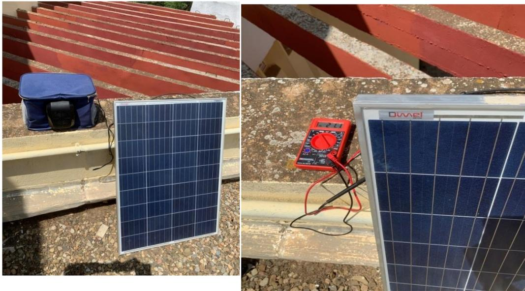
**Figure III.31:**Fonctionnement d'une glacière solaire par un panneau poly cristallin
