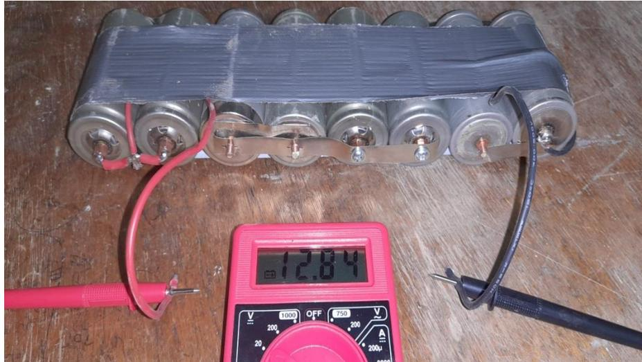
**Figure III.29:**Batterie solaire en série
