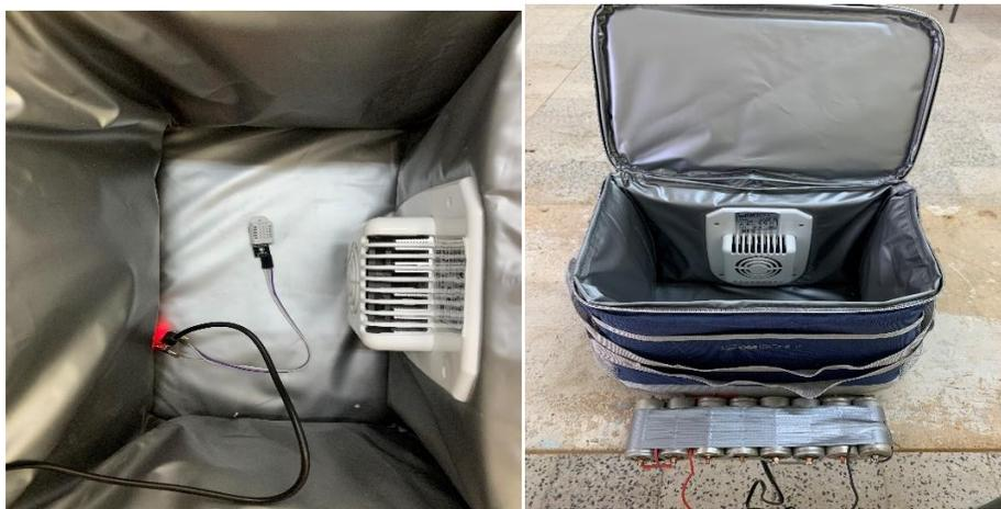
**Figure III.33:** Glacière solaire avec batterie
