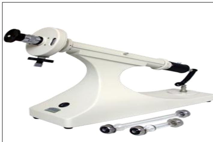
Figure 36: Le polarimètre (76)
