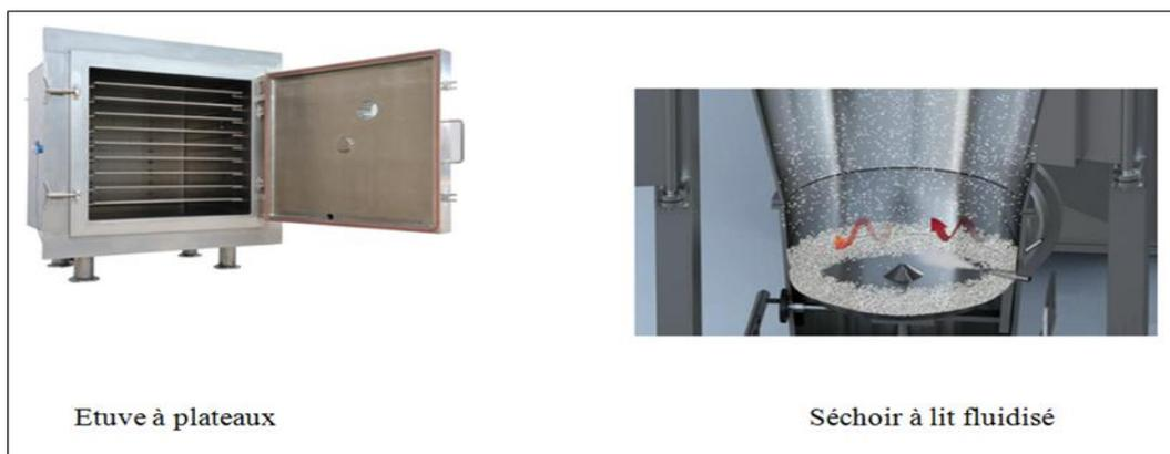
Figure 20: Equipements du séchage. (66)
