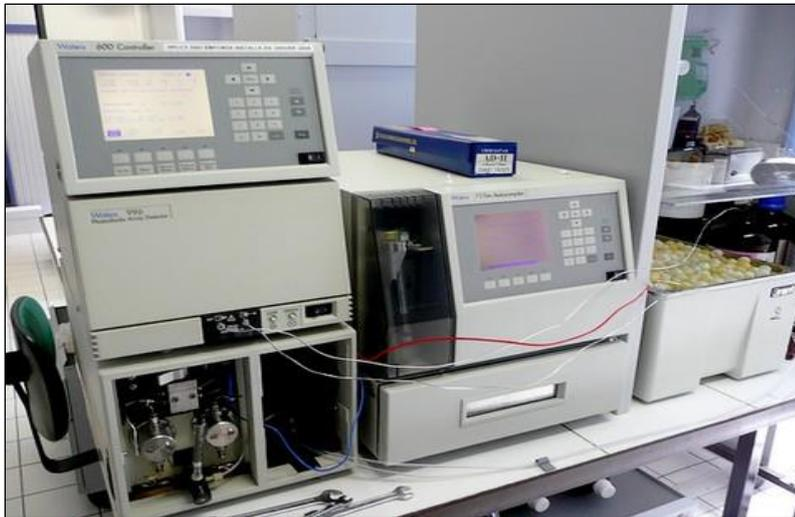
Figure 39 : Instrument de la chromatographie liquide (79)
