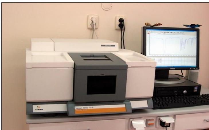
Figure 30: Spectromètre IR à transformée de Fourier (71)
