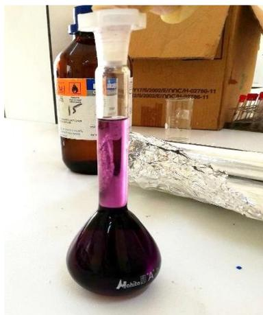
**Figure 47** : Préparation de la solution méthanolique de DPPH°.
