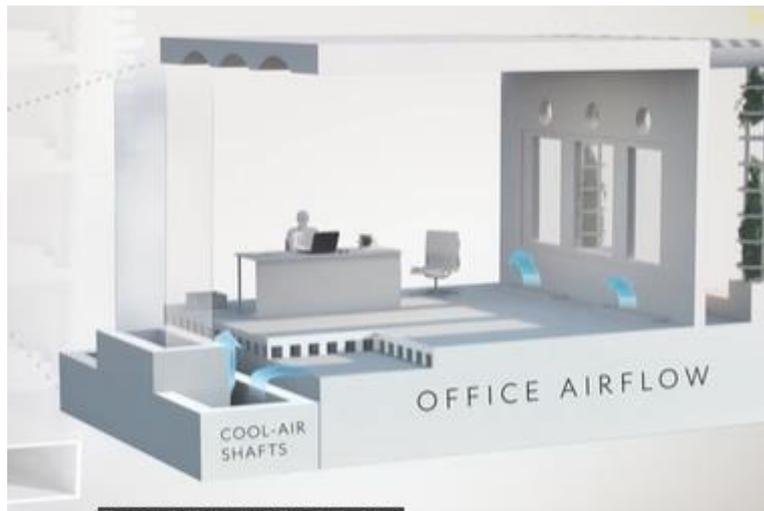
Figure 140: Circulation de l'air refroidisse
