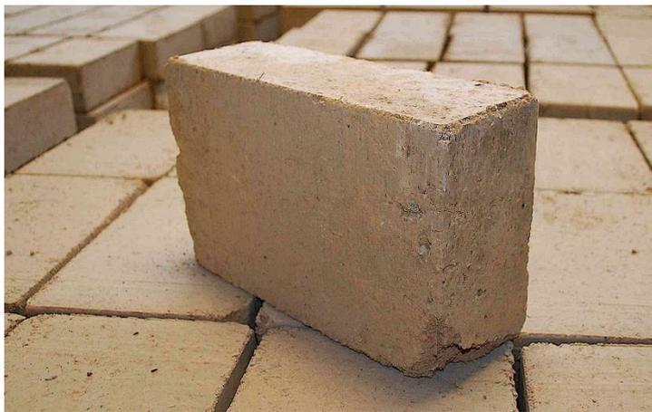
Figure 143: Brique de sable comprimé (Source : google image)
