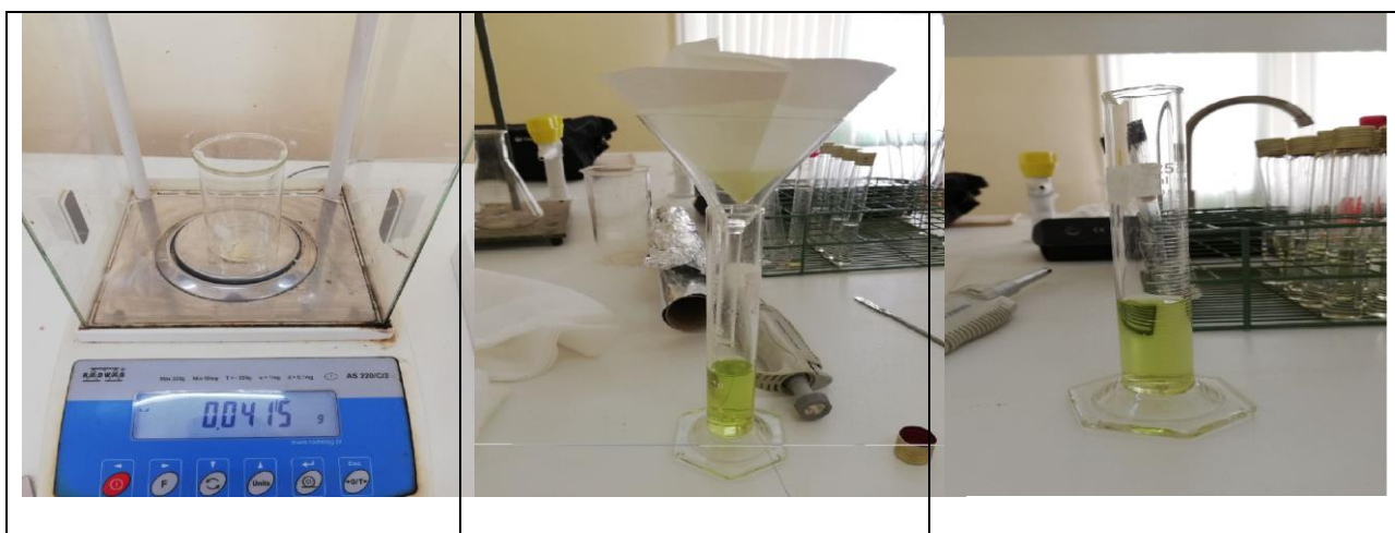
Figure 28 : Préparation de l'extrait méthanolique de l'acide ascorbique.
