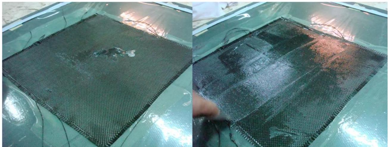
**Figure II.6 :** Résine coulée sur le tissu à l'aide d'un rouleau.
