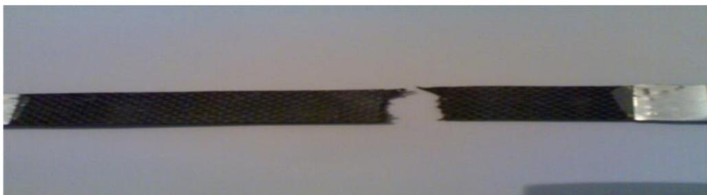
**Figure III.3** Zone de rupture de l'éprouvette.
