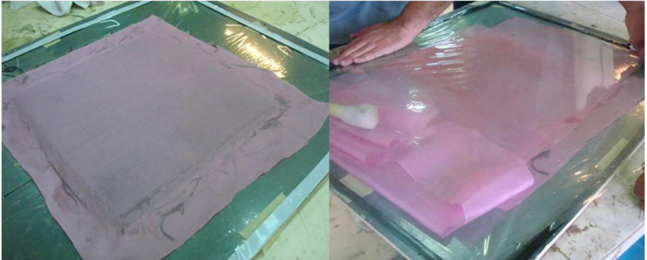
**Figure II.7 :** Stratifié recouvert avec du tissu d'arrachage et du nylon Spécial pochète.
