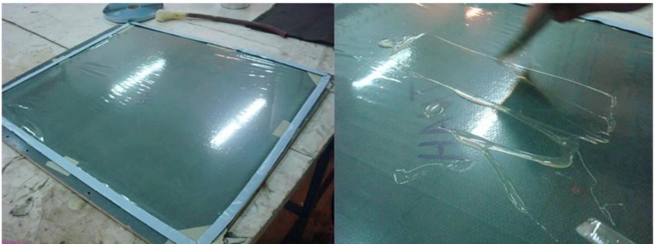
**Figure II.5 :** Résine étalée sur le nylon.
