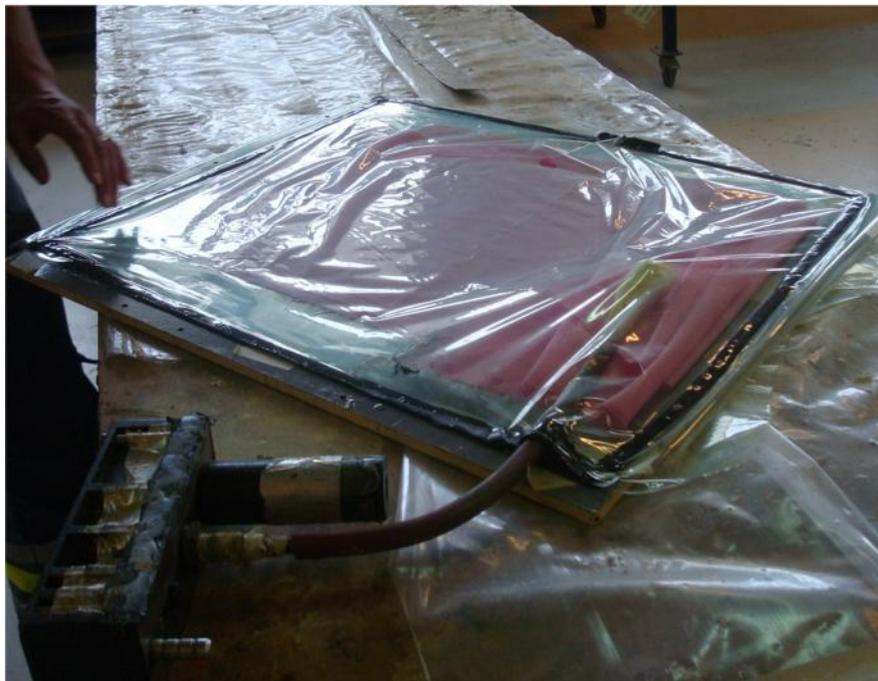
**Figure II.8 :** Stratifié branché avec une pompe à vide.
