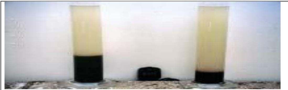
**Figure IV.14** : Test en éprouvettes après 30 mn – eau interstitielle chargée
