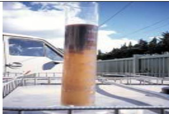
**Figure IV.9** : Test en éprouvette – Remontée de boue
