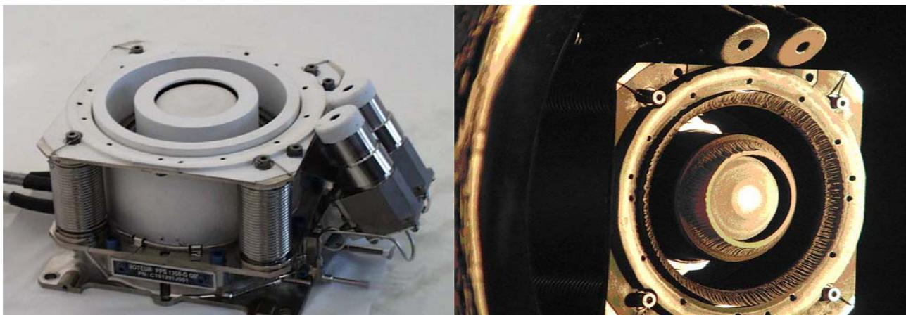
**Figure II-7:** « à gauche: un PPS<sup>®</sup>1350 neuf », « à droite: un PPS<sup>®</sup>1350 après fonctionnement ».
