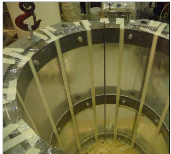
Mise en place du film plastique au dessus de la graisse
