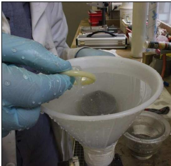
Mise en place de la membrane sur la pointe du piézocône
