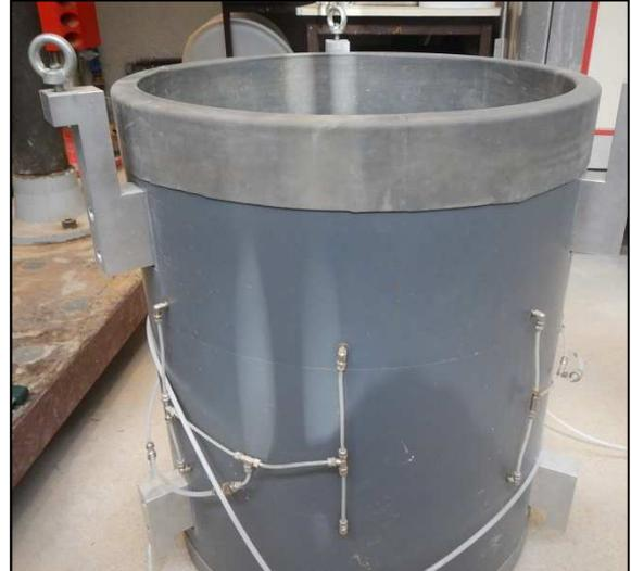
Mise en place de la membrane dans le plaqueur de membrane
