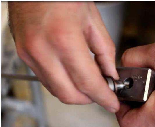
Fermeture de la chambre de mesure du piézomètre
