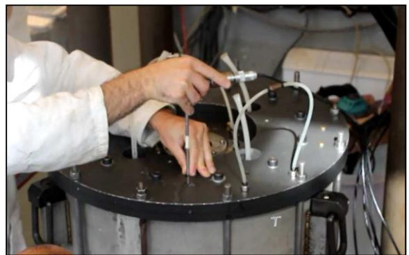
Enfoncement du piézomètre jusqu'à la profondeur voulue
