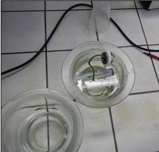
Mise en place de la glycérine, écrou et seringue dans le dessiccateur
