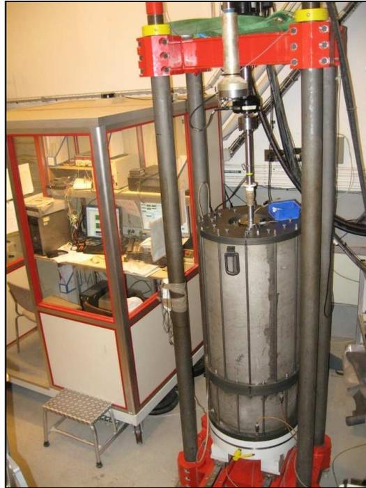
Figure 1.1: Vue d'ensemble de la chambre d'étalonnage du CERMES (ENPC, Paris), France
