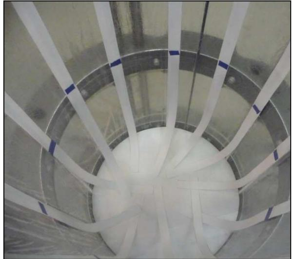
Insertion du disque de plastique poreux sur l'embase inférieure ainsi que les bandes de papier filtre
