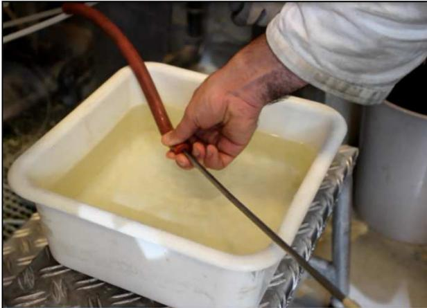
Branchement du piézomètre au réservoir d'eau désaérée
