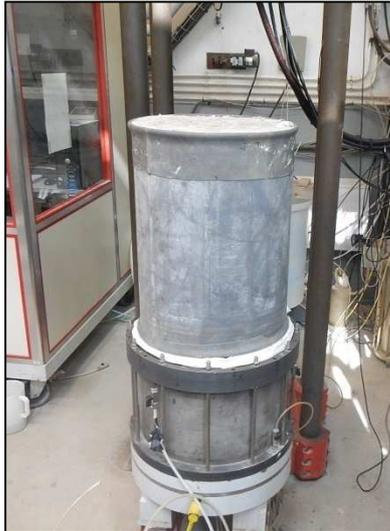
Mise en place de la membrane sur le massif
