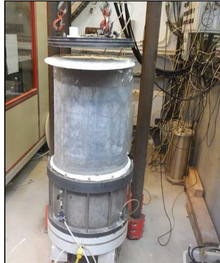
Enlèvement du disque de plastique poreux supérieur et mise en place de la pièce guide et de l'embase supérieure
