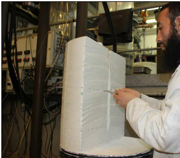
Essai au pénétromètre de poche
