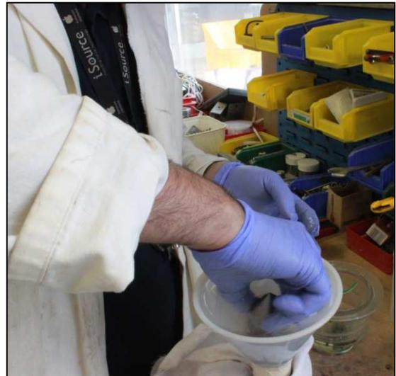
Serrage de la pointe sur le corps du piézocône
