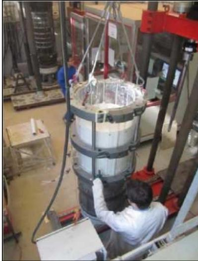
Mise en place du moule au dessus du piston de la chambre d'étalonnage
