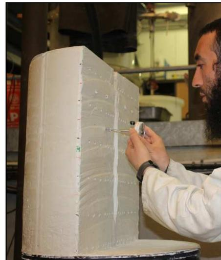
Essai au scissomètre de poche
