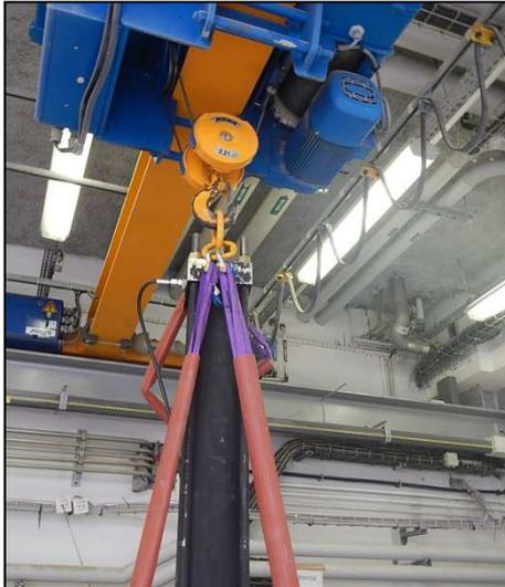
Suspension du dispositif de consolidation à l'aide du pont roulant
