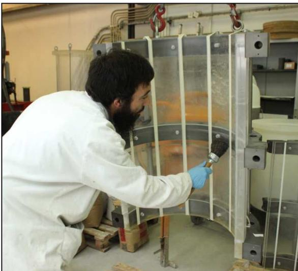
Mise en place de la graisse
