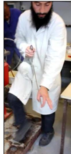
Fermeture de l'extrémité du piézomètre par le "bout de doigt"
