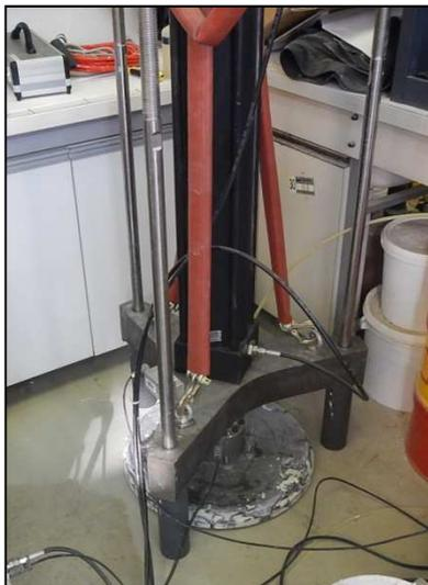
Vérin de chargement déposé sur les cales à l'aide des 3 tiges
