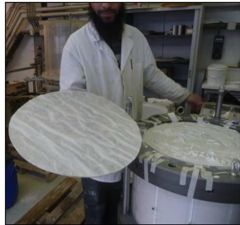
Mouillage et mise en place du papier filtre et du disque poreux
