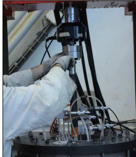
Assemblage du dispositif d'accrochage du piézocône
