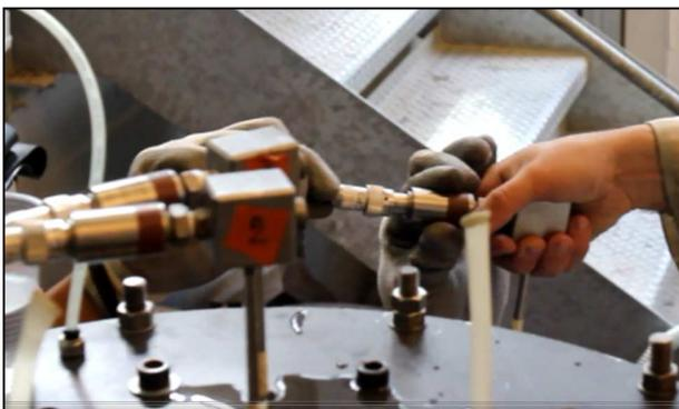
Connexion du piézomètre avec le système d'acquisition
