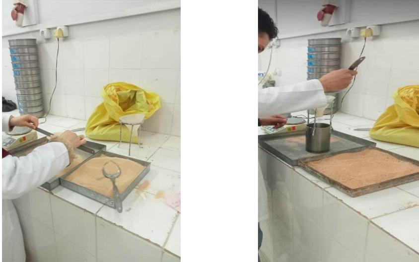
**Figure III.9 :** Essai pour déterminer la masse volumique apparente.
