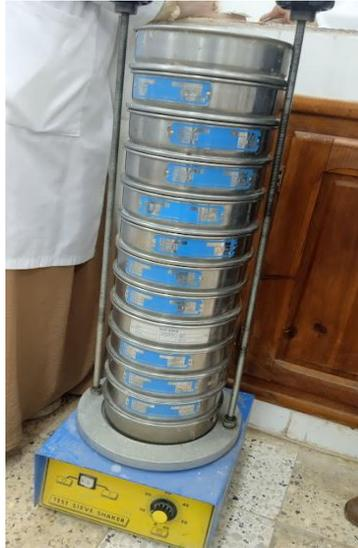
**Figure III.1 :** Machine à tamiser
