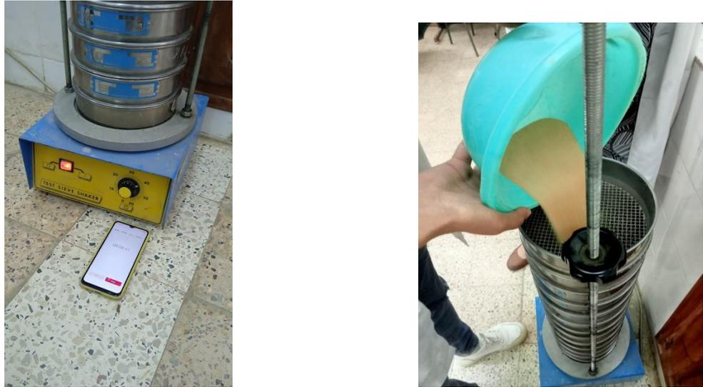
**Figure III.2 :** Essai de l'analyse granulométrique.
