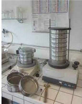
**Figure II.1** Essai analyse granulométrique par tamis.
