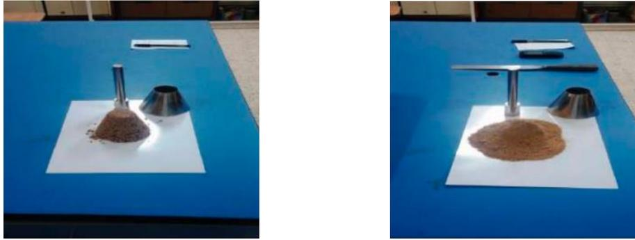
**Figure II.7 :** Essai détermination du Coefficient d'absorption
