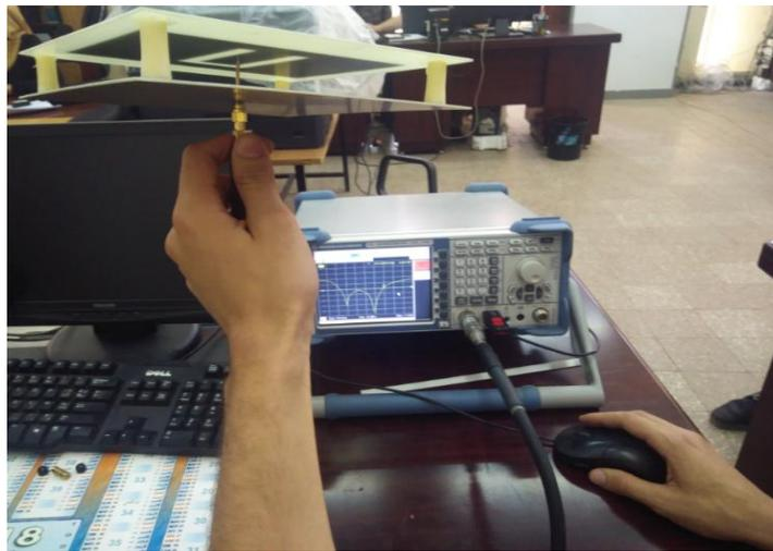
Figure 4.5. Antenne patch avec U-Slot sous test.
