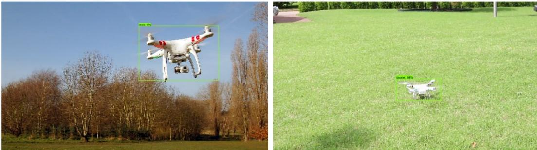
FIGURE 3.22 – Résultats obtenue du modèles SSD-MobileNet
