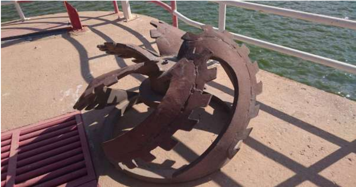
Photo 3.2 : Désagrégateur utilisé par la drague [15].
