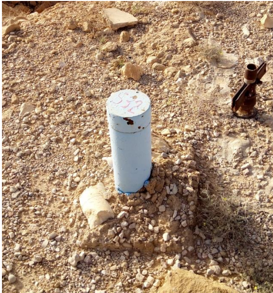
Fig. 3.12. Piézomètre fonctionnel de la rive gauche Piézomètre S32 (photo. Mai 2017)
