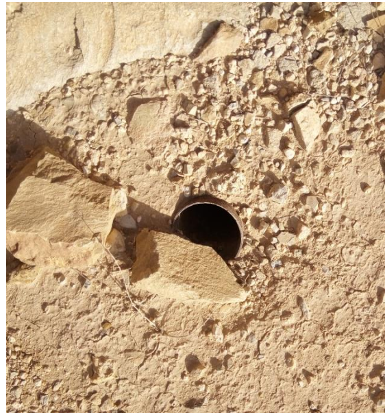
Fig. 3.13. Piézomètre obturé non utilisable (photo. Mai 2017)
