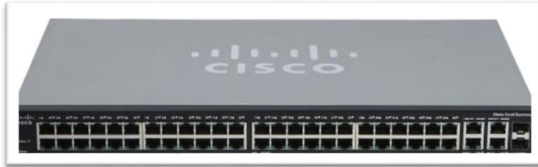
Figure 3.2 : Un Commutateur De Réseau (Switch) [41]
