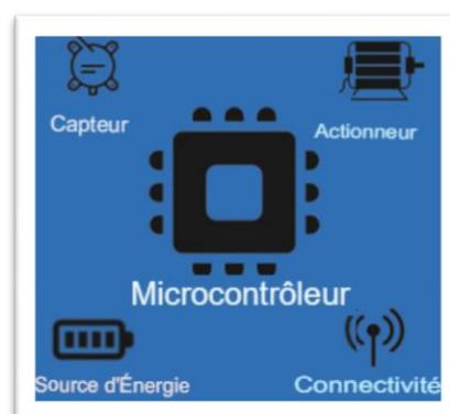
Figure 2.3 : Schéma fonctionnel des objets intelligents typiques (smart objet) dans l'IOT [32]
