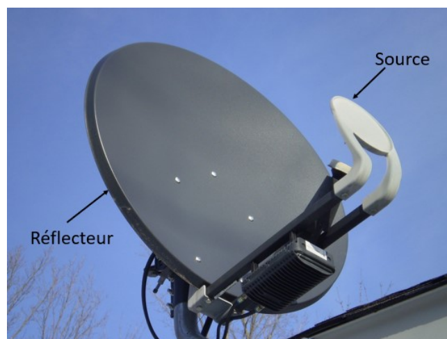
FIGURE 1.8 – Antenne parabolique de type offset a foyer décalé.
