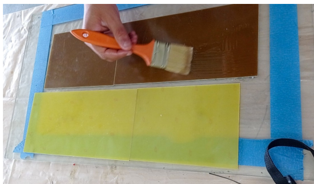
FIGURE 4.14 – Étalement de la résine Epoxy.
