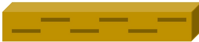
FIGURE 1.12 – Exemple d'antenne à fente.
