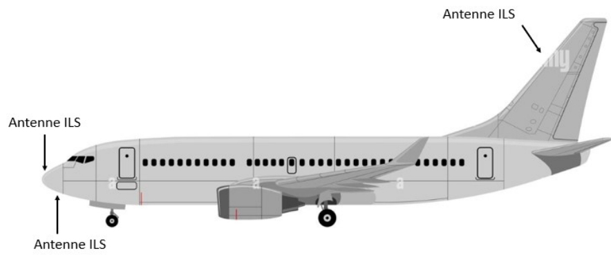
FIGURE 2.7 – Disposition possible des antennes ILS.
