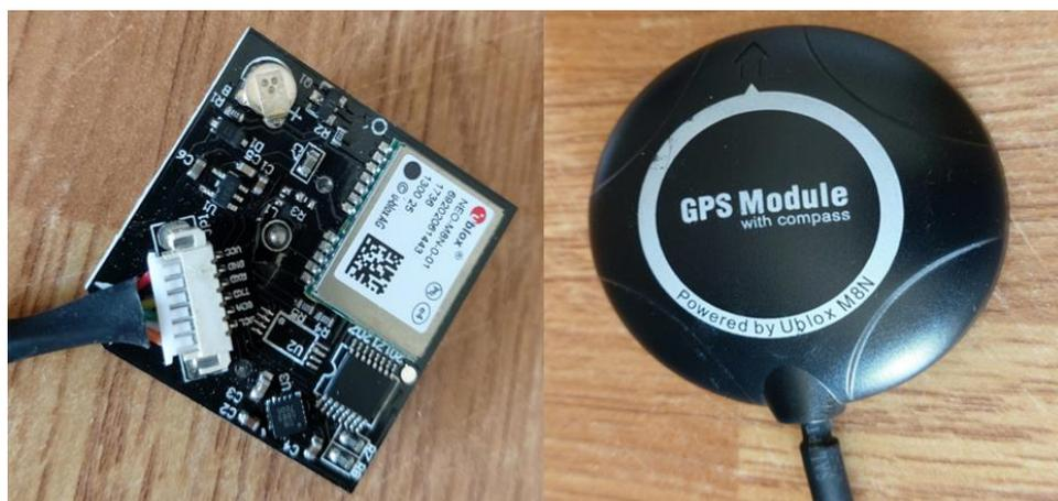
**Figure III-5** Vue du module GPS u-blox M8N.
