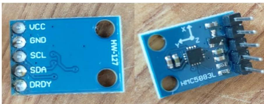
**Figure III-3** Vue de module Magnétomètre HMC5883L.
