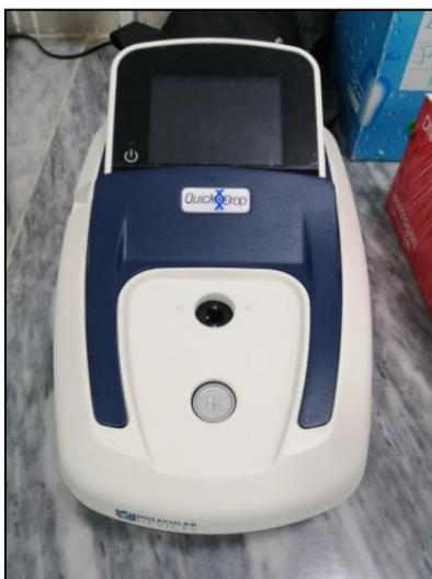
Spectrophotomètre (SpectraMax® Quick Drop™).
