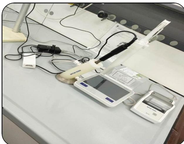
**Figure 40 :** Conductimètre.
