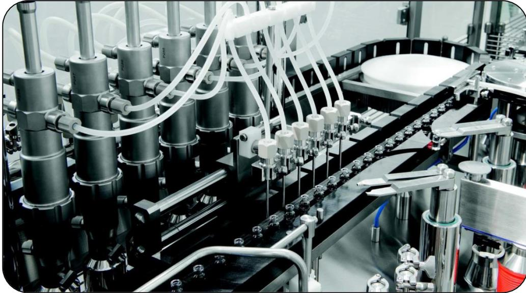
**Figure 19 :** Machine à remplissage d'ampoule
