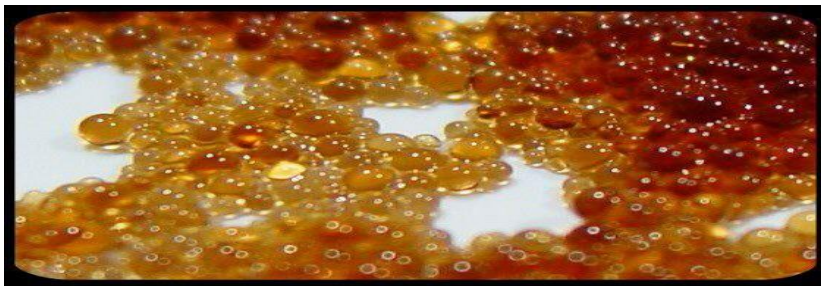
Figure 12 : microbille de résine échangeuse d'ions (23)
