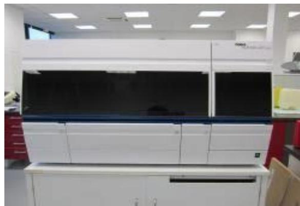
Figure 22: Un automate de biochimie COBAS INTEGRA® 400
