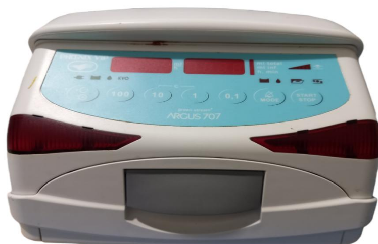
Figure IV-7 : Pompe volumétrique de nutrition parentérale.
