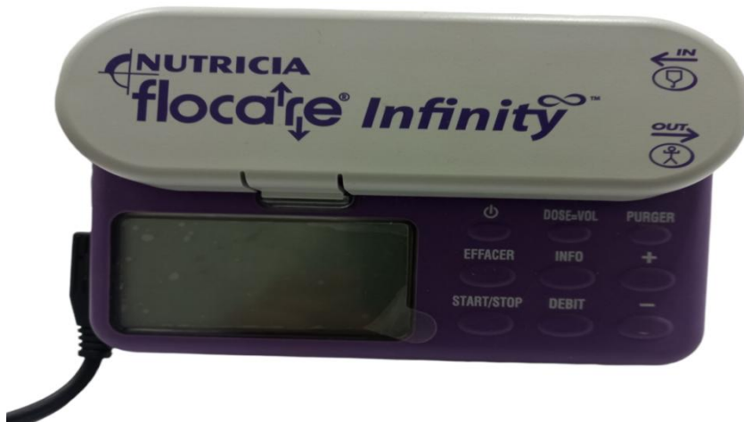
Figure IV-5 : Pompe volumétrique de nutrition entérale.
