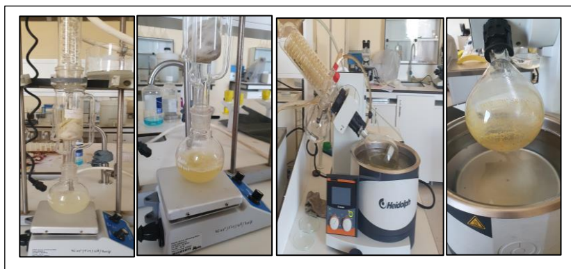
Figure 54 : les étapes d'extraction de la silymarine
