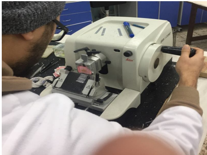
Figure 14: Réalisation des coupes histologiques par le microtome
