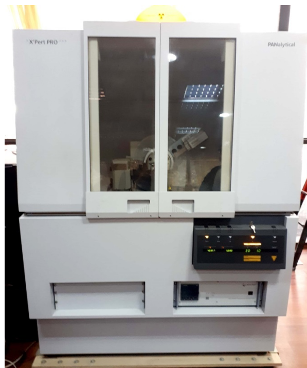
Figure 2.8: Diffractomètre de type X'PERT Pro Panalitical.
