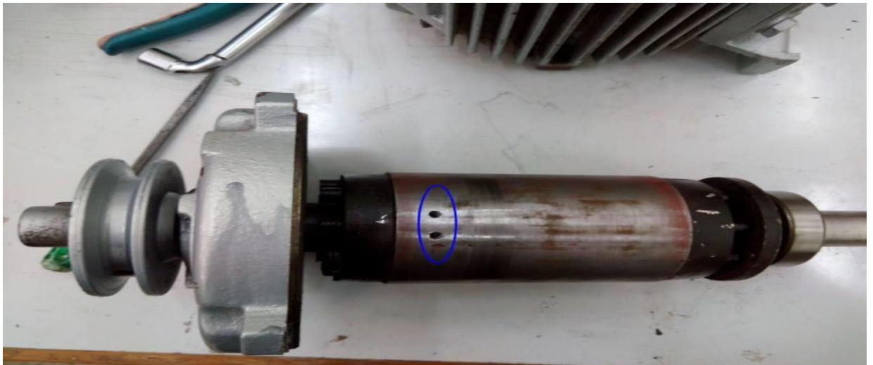
Figure 4.11. Rotor à cage avec deux barres cassées.
