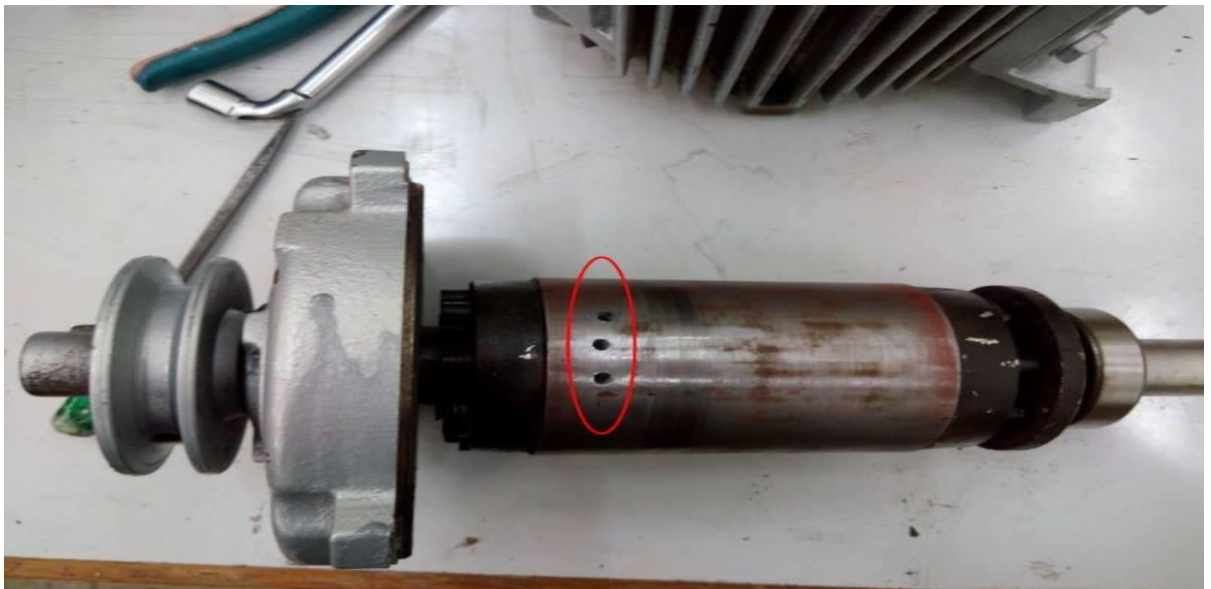
Figure 4.16. Rotor à cage avec trois barres cassées.
