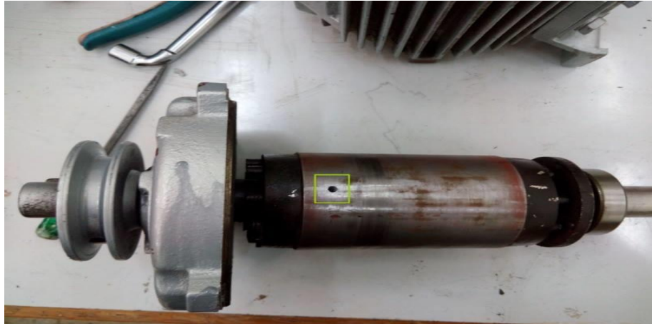
Figure 4.6. Rotor à cage avec une barre cassée.
