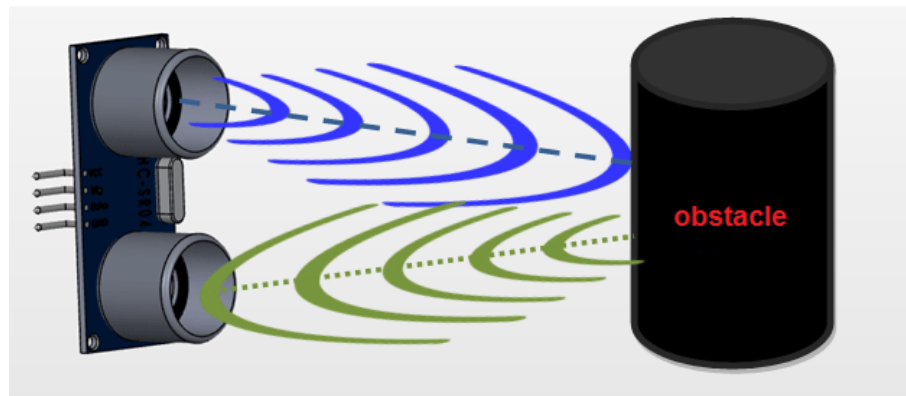
Figure II.17: Détection d'obstacle par ultrason.
