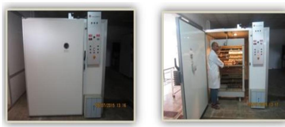
**Figure 15** - Incubateur à grande capacité de type VICTORIA au niveau de couvoir de CCZ (Original, 2015).
