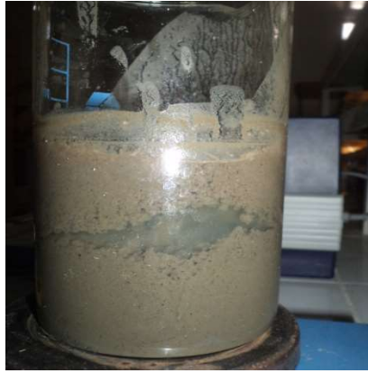
Figure VI.11 : Boue obtenue après électrocoagulation, pour i=200\text{A.m}^{-2} et T=45\text{min} .
