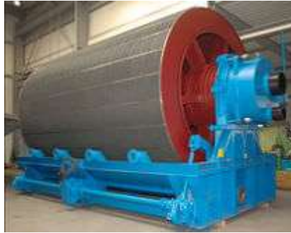
Figure II.3 : Filtres à tambour sous vide (c).
