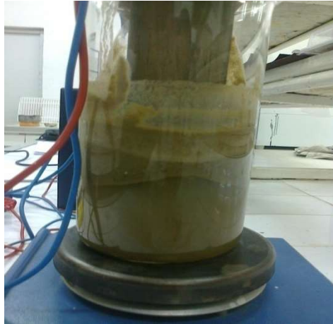
Figure VI.6 : Boue obtenue après électrocoagulation, pour i=250\text{A.m}^{-2} et T=15\text{min} .
