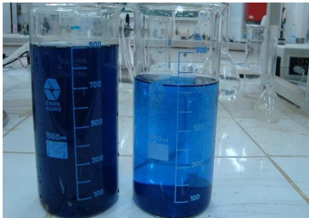
**Figure 4.24** Aspect de la solution avant et après la coagulation – floculation
