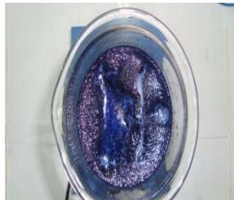
**Figure 4.22** Photos de l'écume formé pendant le traitement d'EC.
