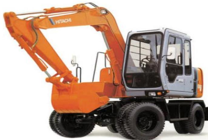
*Figure 3.34. Pelle équipée en rétro*
