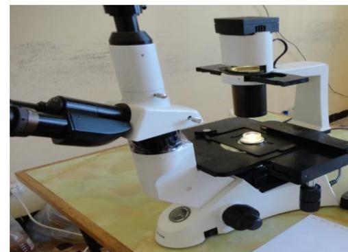
**Fig. 03 :** Microscope inversé
