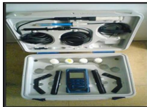
**Fig. 02 :** Analyseur multiparamètre de type W.T.W 340i
