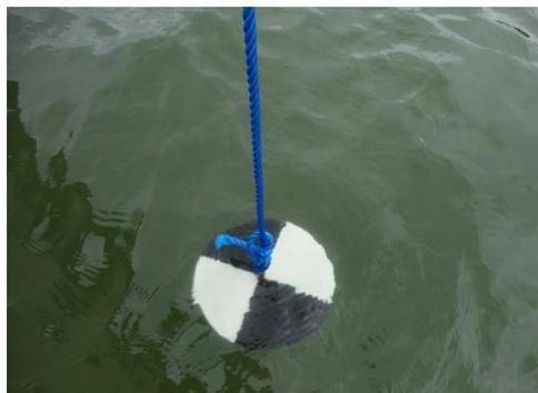
**Fig. 01 :** Disque de Secchi
