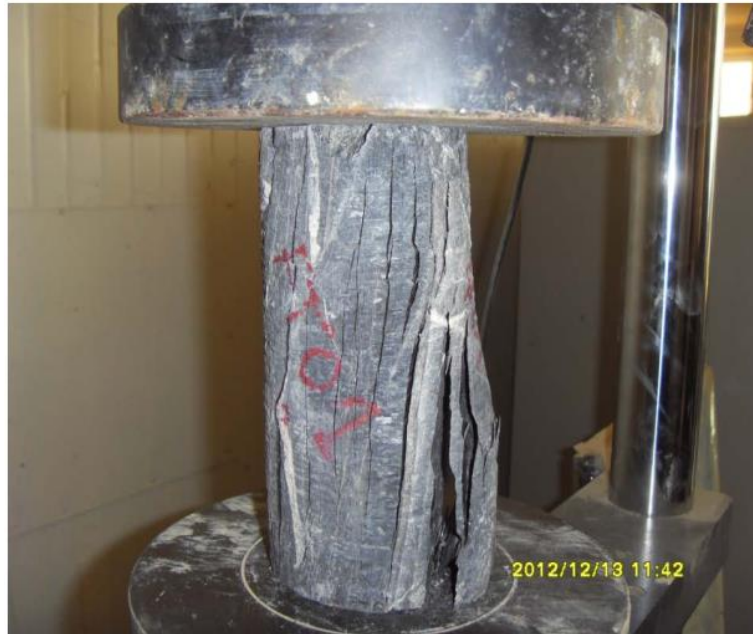
Figure II-17 : Exemple de rupture de la carotte de roc selon des plans quasi-verticaux.
