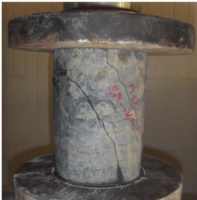
Figure II-18 : Exemple de rupture de la carotte du roc selon un plan incliné.
