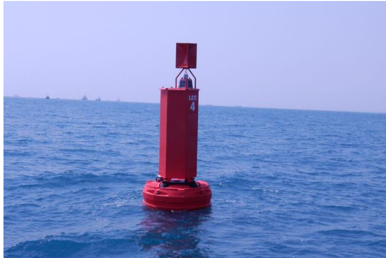
Figure 2.6 : Exemple d'une bouée de balisage maritime (27) .
