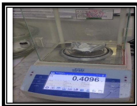
Figure 20 : Peser 400mg de NovaZinc Ultra 30mg dans une Balance ( Originale 2023 ).
