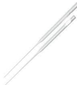
**figure16 :** Pipette pasteur
