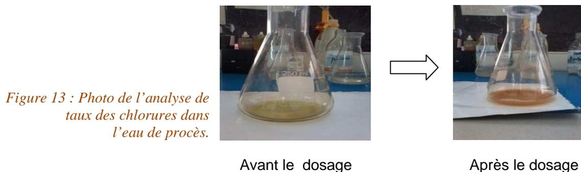
*Figure 13 : Photo de l'analyse de taux des chlorures dans l'eau de process.*
