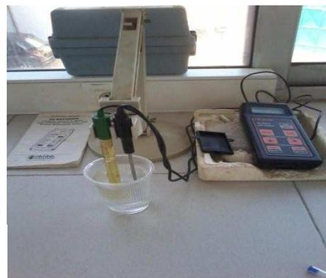
*Figure 9 : Photo la mesure de pH (pH mètre)*
