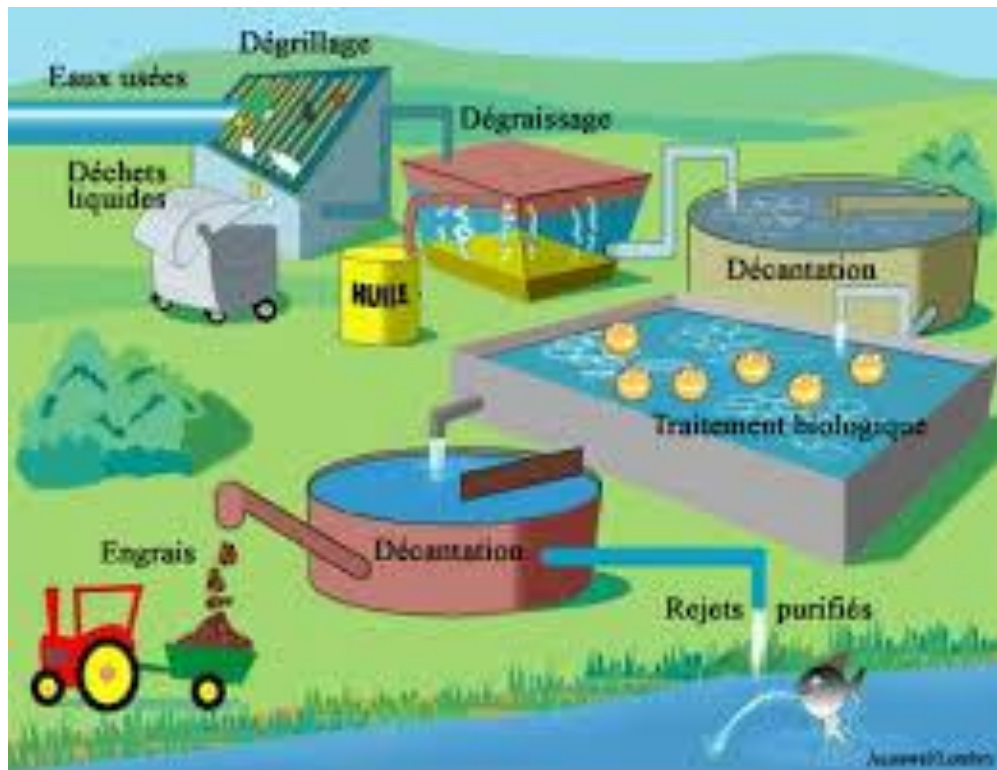
Figure 1:schéma synoptique de station d'épuration.
