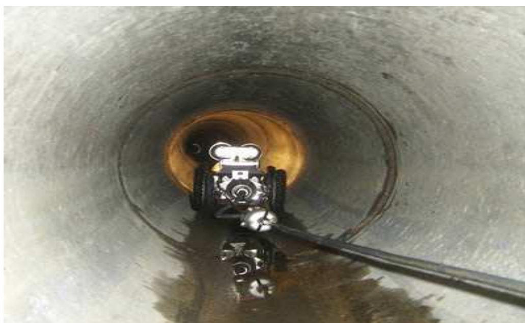
Figure 19 : Photo d'une inspection télévisée, Source : [8]
