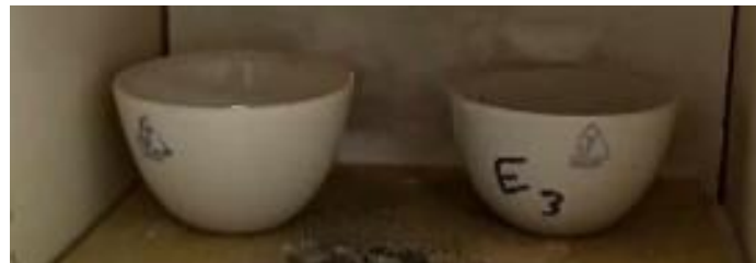
Figure 4.1 : Représentant les creusets introduits dans la chambre à chauffage.
