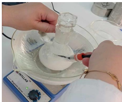
Figure 4.4 : Représente l'agitation de la suspension pendant l'injection de CO 2 .
