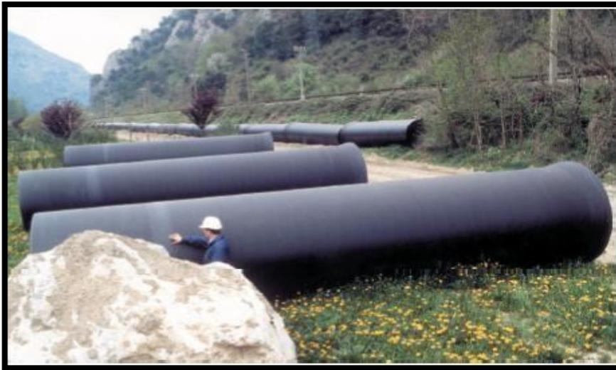
**Figure III.8** : Conduites en fonte ductile
