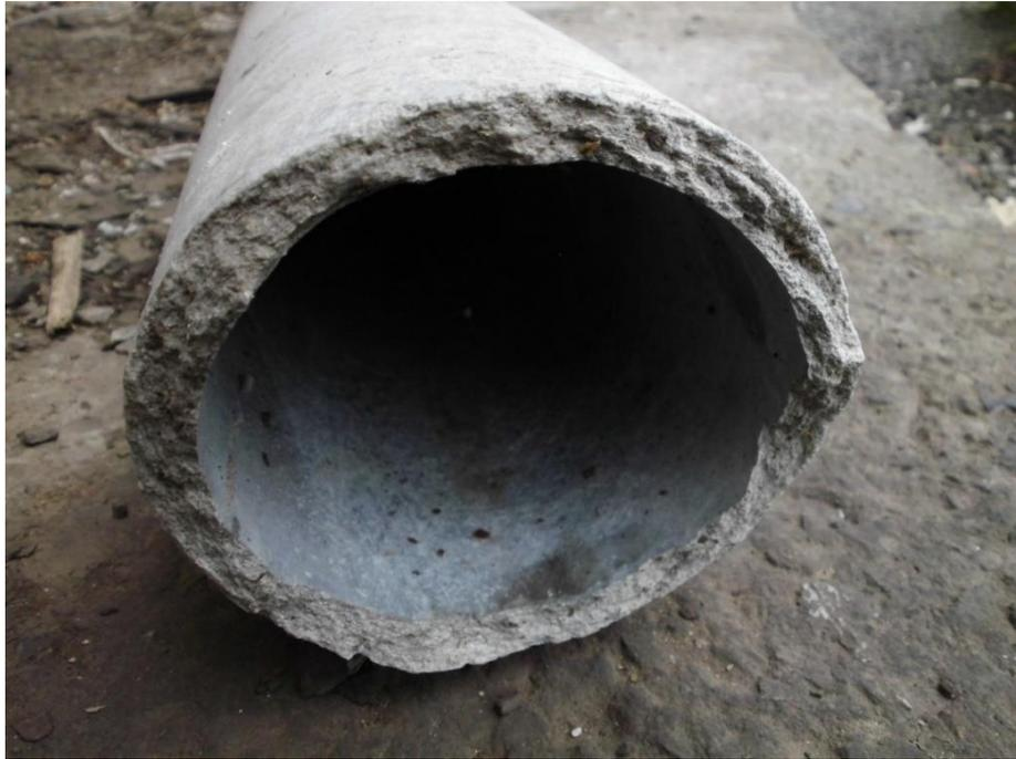
**Figure III.9** : Canalisation en amiante ciment.
