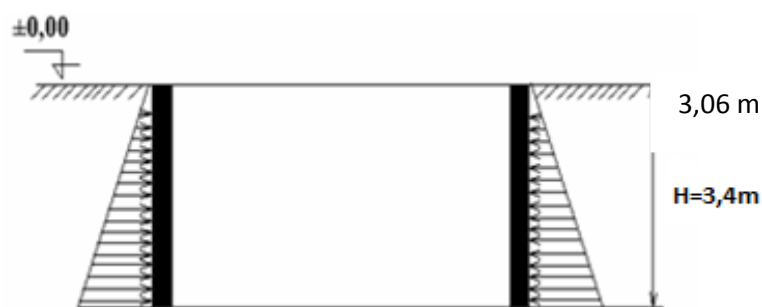
Figure VI . 9: Poussées des terres.
