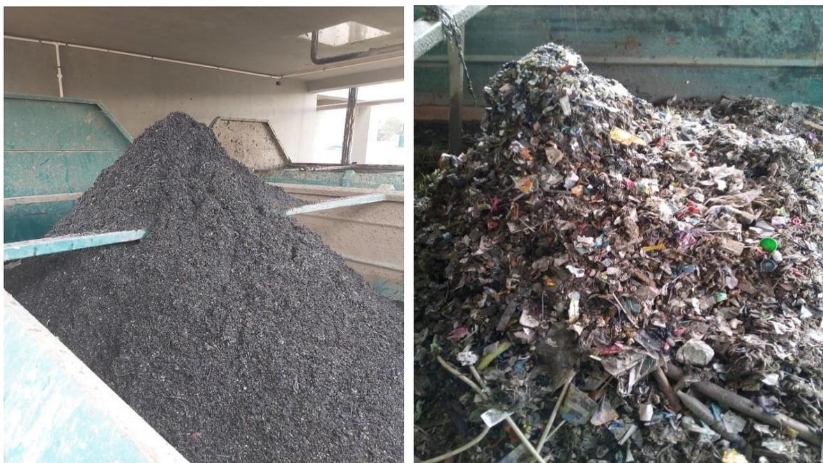
**Figure IV.18 :** Refus de dégrillage et de dessablage
