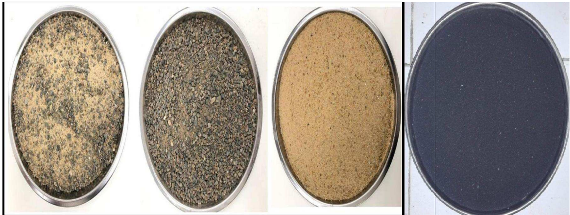
Figure 3.2: Échantillon des différents sables : sable corrigé, sable de Baghlia, sable boughzoul et sable de fonderie.
