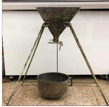
Figure 3.7: Essai V- funnel pour mortier autoplaçant.
