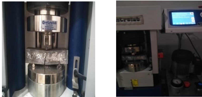
Figure 3.9 : Essai de la résistance à la traction par flexion.
