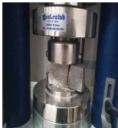
Figure 3.8: Essai de la résistance à la compression.
