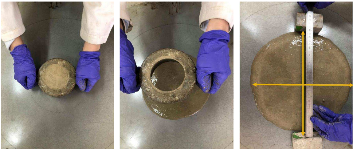
Figure 3.6: Essai d'étalement pour mortier autoplçant.
