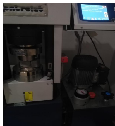
Figure 3.8: Essai de la résistance à la compression.
