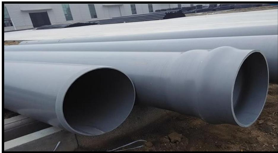
**Figure III.4:** Conduite circulaire (PVC)
